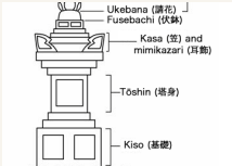
宝篋印塔开放部件图：层级、笠部与相轮 作者：Urashimataro 许可：Public domain · 原始文件页 处理：等比缩放；未改变部件关系
