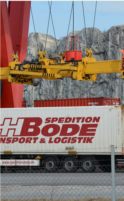
集装箱吊具：箱体限重不等于日本道路可运输净重 Bengt Oberger · CC BY-SA 4.0 · 横向裁切；未改变内容
